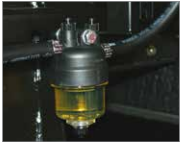
▲ Water separator filter Filtre séparateur eau
