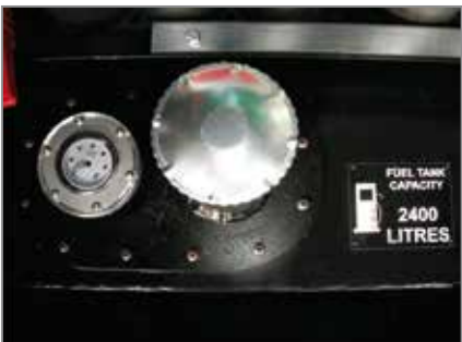
Oversized fuel tank Réservoir surdimensionné
