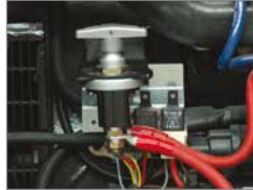
▲ Battery isolator switch Interrupteur coupe-batterie
