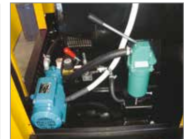
▲ Automatic fuel refilling kit Kit de remplissage automatique
